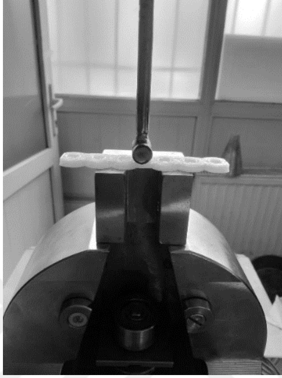
Şekil 4.10 Plaklara uygulanan üç noktalı bükme testi
