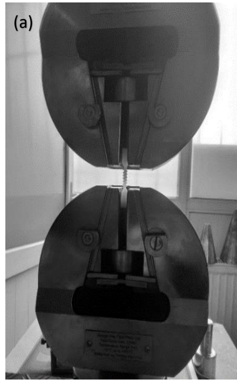
Şekil 4.11 Vida testleri. (a) Çekme testi. (b) Tork testi
