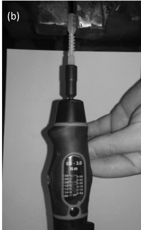
Şekil 4.11 Vida testleri. (a) Çekme testi. (b) Tork testi
